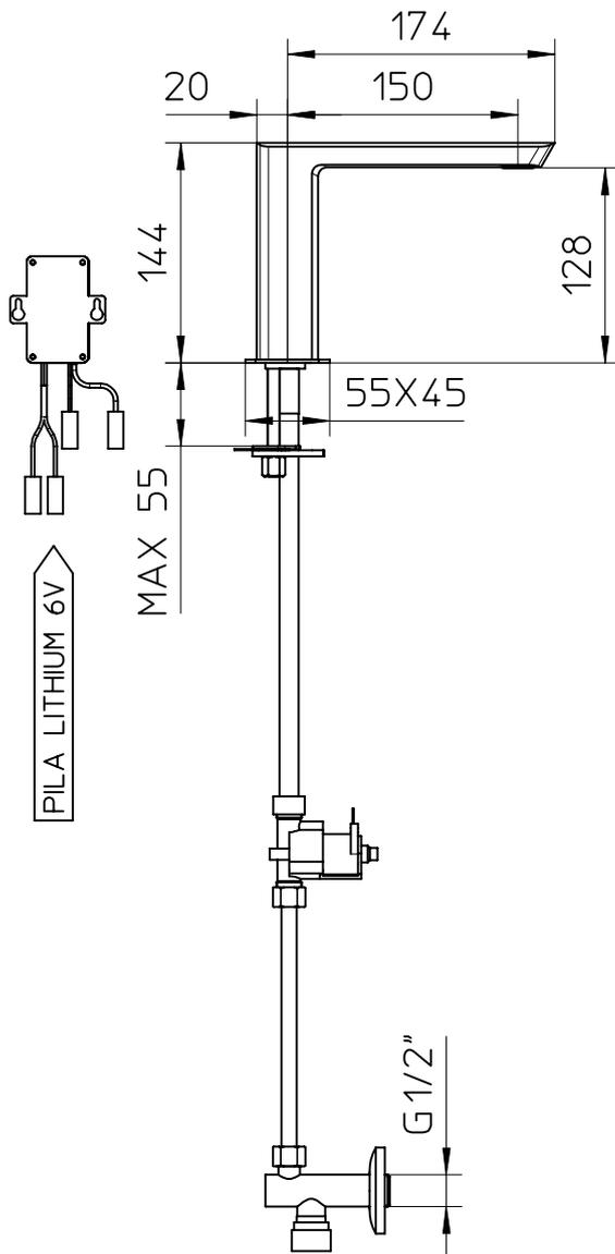
Attenzione: il rubinetto deve essere elettricamente isolato (messa a terra) per funzionare correttamente.
